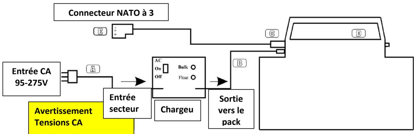
Avec un voltmètre approprié, vérifiez les tensions aux points indiqués.
