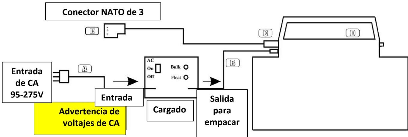
Con un Voltímetro adecuado controlar las tensiones en los puntos indicados.
