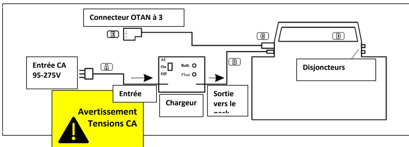
**Avec un voltmètre approprié, vérifiez les tensions aux points indiqués.**
