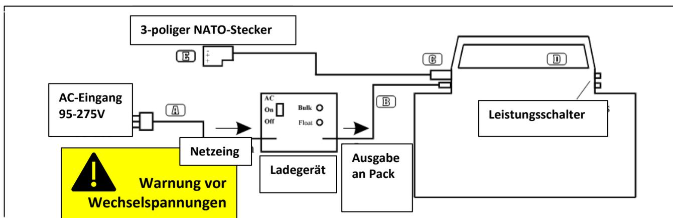
**Prüfen Sie mit einem geeigneten Voltmeter die Spannungen an den dargestellten Punkten.**
