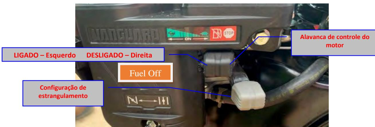
4. Mover a alavanca preta superior para a direita – interrompe o funcionamento do motor e desliga a válvula de combustível. Mova para a esquerda para correr.
