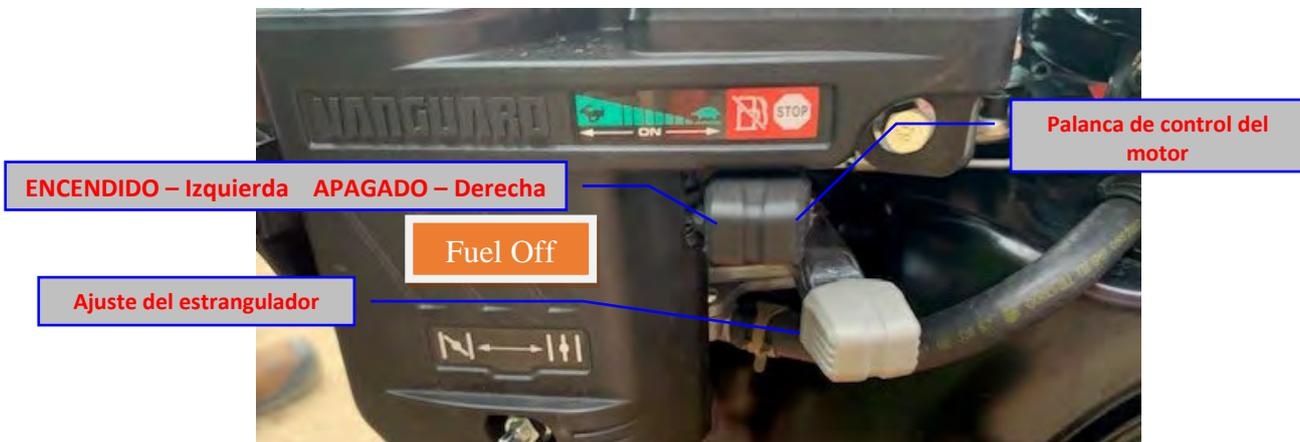
4. Mover la palanca negra superior hacia la derecha: detiene el funcionamiento del motor y cierra la válvula de combustible. Muévete hacia la izquierda para correr.
